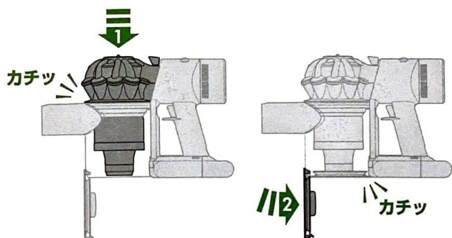
必ず最初にサイクロン部分をクリアピン内に押し入れて格納してから、クリアピンの底を閉めてください。
